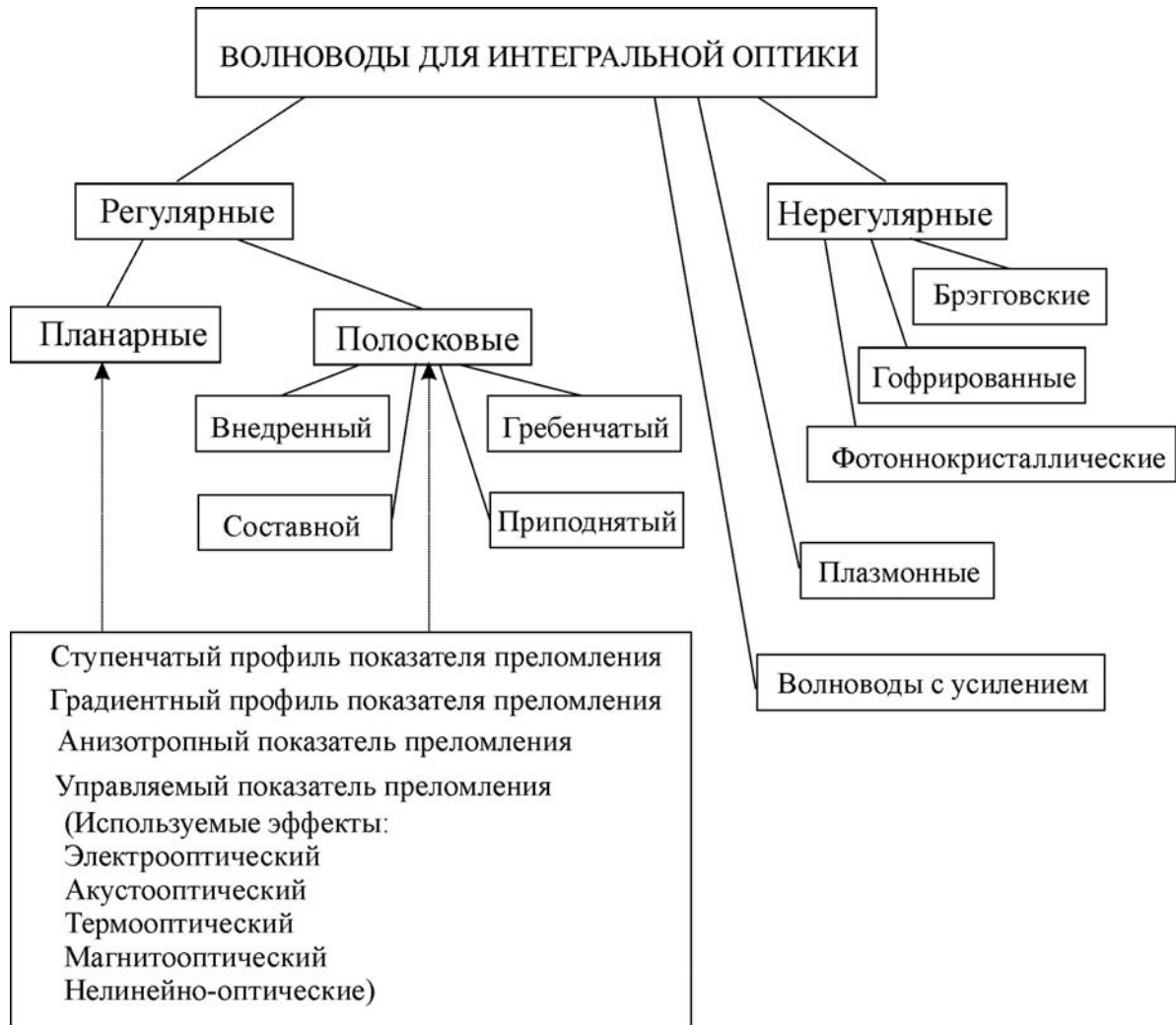
Рис. 1.1. Классификация волноводов для интегральной оптики
